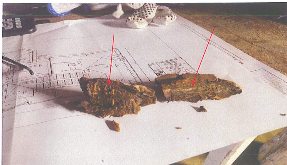
Foto nr 27. Owoce grzyba który rozwinął się w miejscu destrukcji mikologicznej w objętości krokwi. Owocnik w formie skórzastym, grubej narośli.
